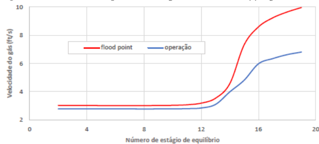
Figura 9. Velocidade superficial do gás dentro da stripping.
